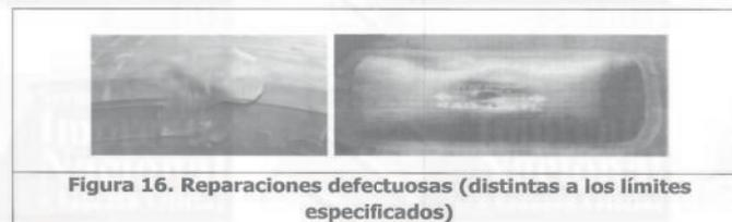
Figura 16. Reparaciones defectuosas (distintas a los límites especificados)
